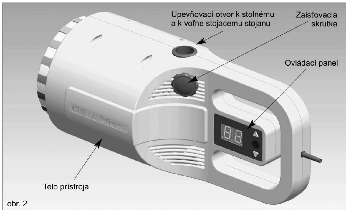
**Upevňovací otvor:** Pomocou tohto otvoru a sa lampa umiestni na stolný stojan a zaskrutkovaním resp. odskrutkovaním zaistovacej skrutky sa lampa zafixuje v požadovanej polohe na stojan.
